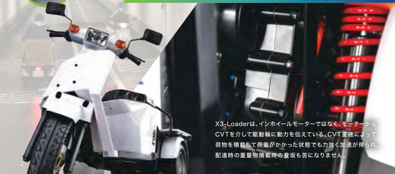
X3-Loaderは、インホイールモーターではなく、モーターからCVTを介して駆動輪に動力を伝えている。CVT変速によって荷物を積載して荷重がかかった状態でも力強く加速が得られ、配達時の重量物積載時の登坂も苦になりません。
